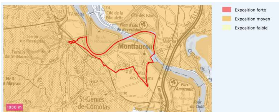
Retrait-gonflement d'argiles - source : Géorisques
