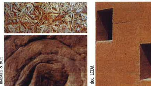
Paillettes de chanvre (chênevotte), laine de chanvre et béton de chanvre banché sur un mur extérieur - un matériau aux aspects et usages multiples.
