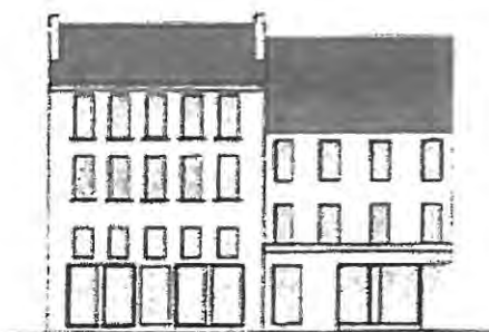
Suppression ou insuffisance de piler à l'angle de deux rues.
