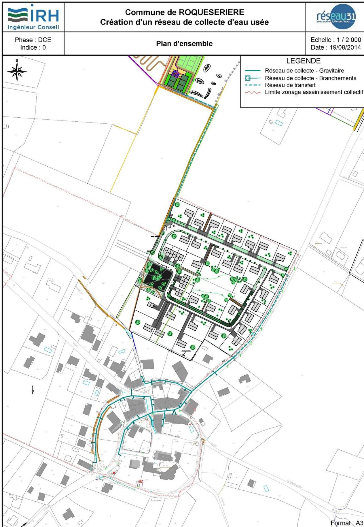
Figure 12: plan du réseau d'assainissement collectif, source schéma communal d'assainissement réalisation IRH
