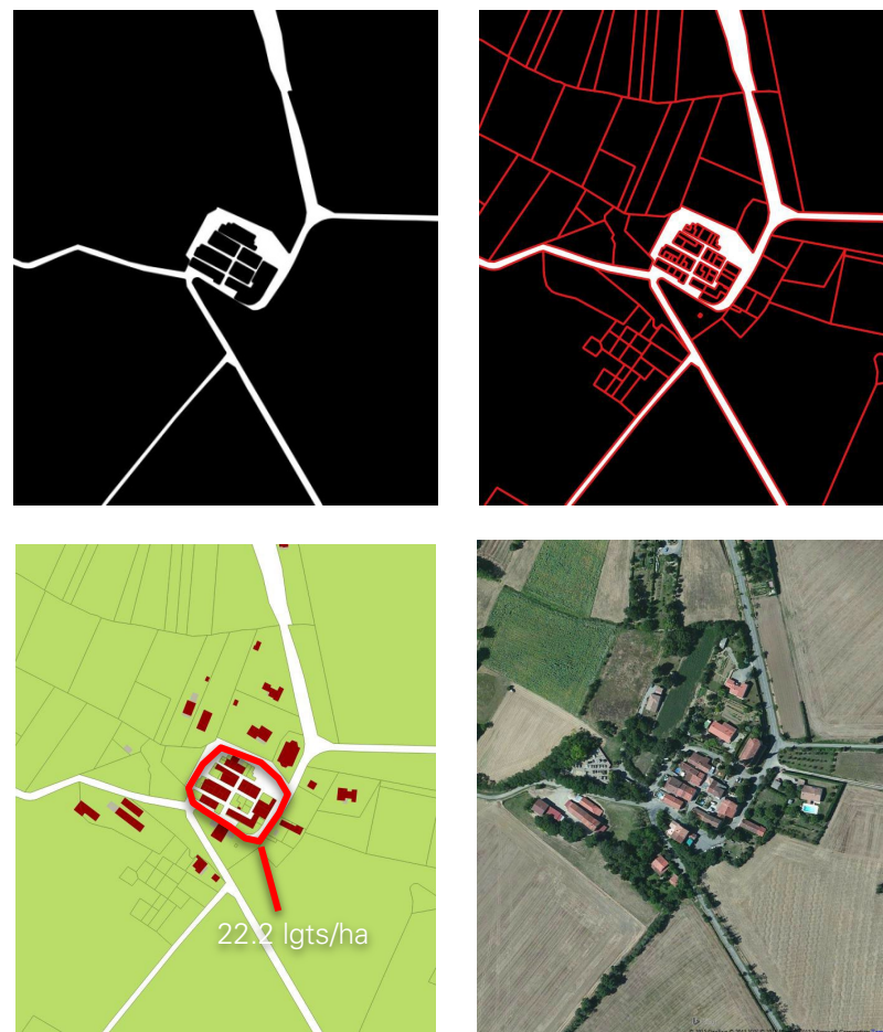
Figure 38 : analyse de morphologie urbaine de l'habitat groupé au lieu-dit « Caussidières », source cadastre et Google Satellite, réalisation Paysages
