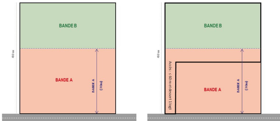
Schéma illustratif des bandes de constructibilité
