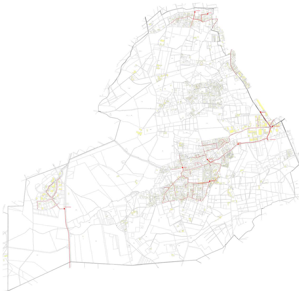
Figure 105 Réseau d'assainissement en 2016 sur Martillac
