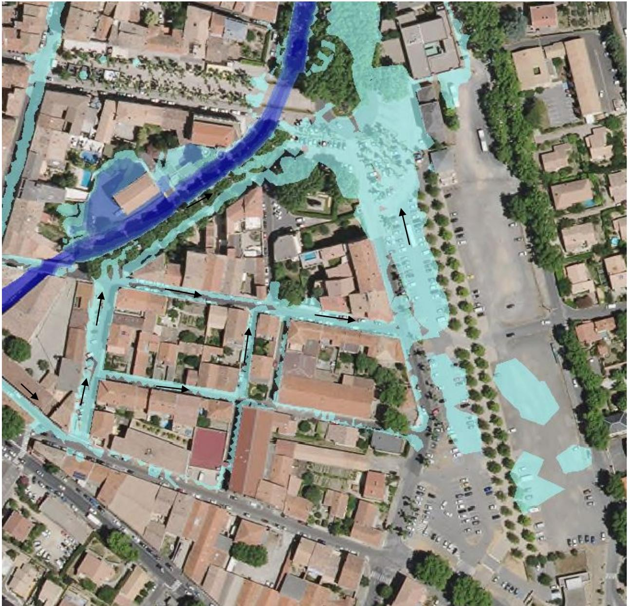
Figure 17 : écoulements sur voirie entre le Ronel et le parking de la gare
