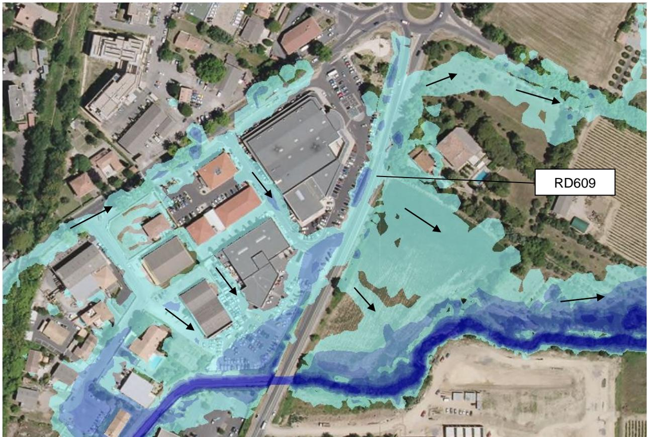
Figure 20 : écoulements de part et d'autre de la RD609
