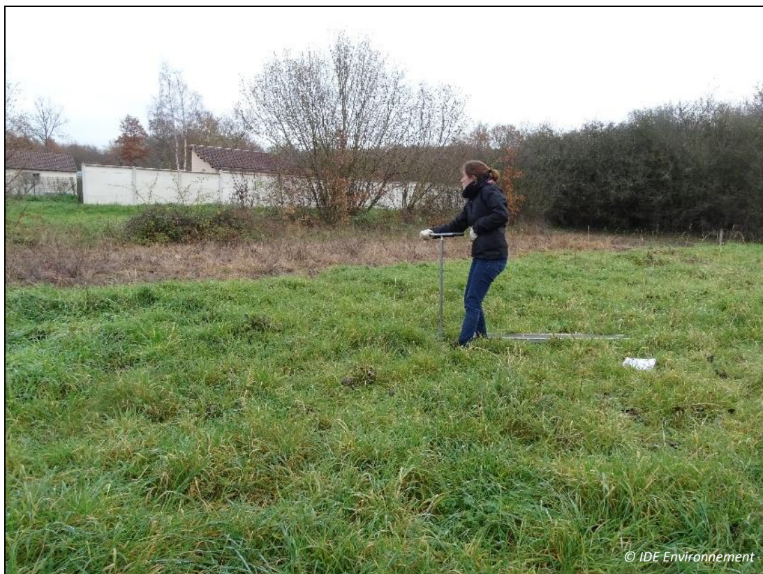
Figure 4 : Sondage à la tarière, décembre 2014
