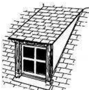
lucarne rampante ou en chien couché
