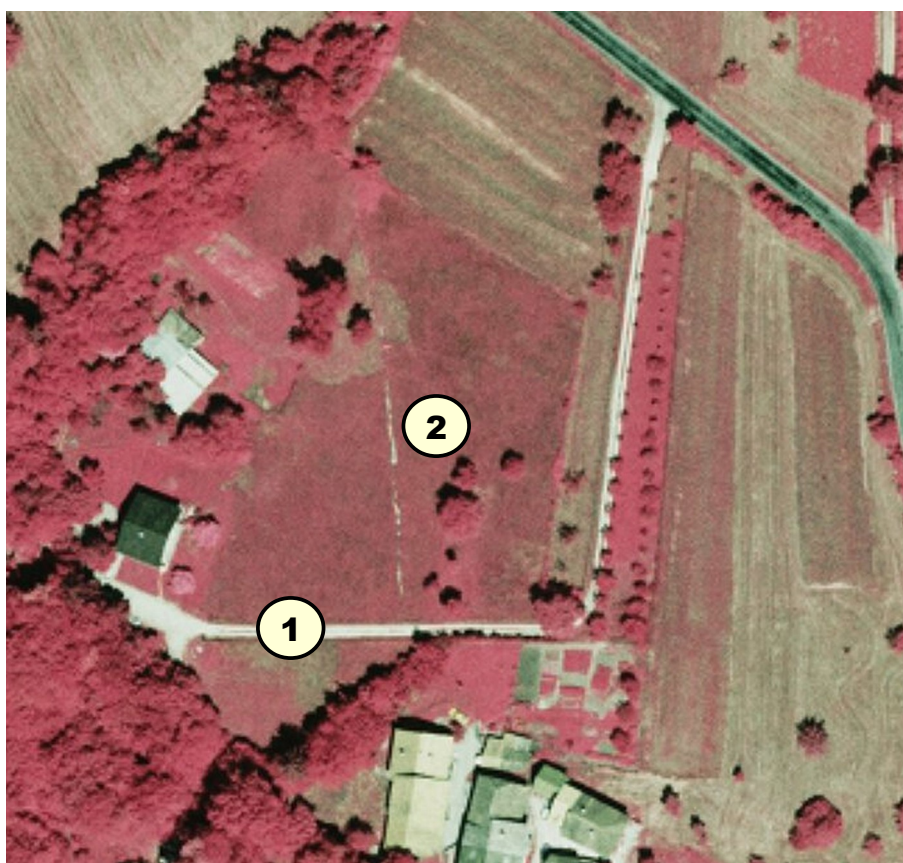
Figure 13: Extrait d'une photographie aérienne (infra-rouge fausse couleur) de juillet 1982. Le ruisseau n'est plus visible à l'aval du chemin d'accès à la maison (1). La trace (2) pourrait être celle d'une canalisation.
