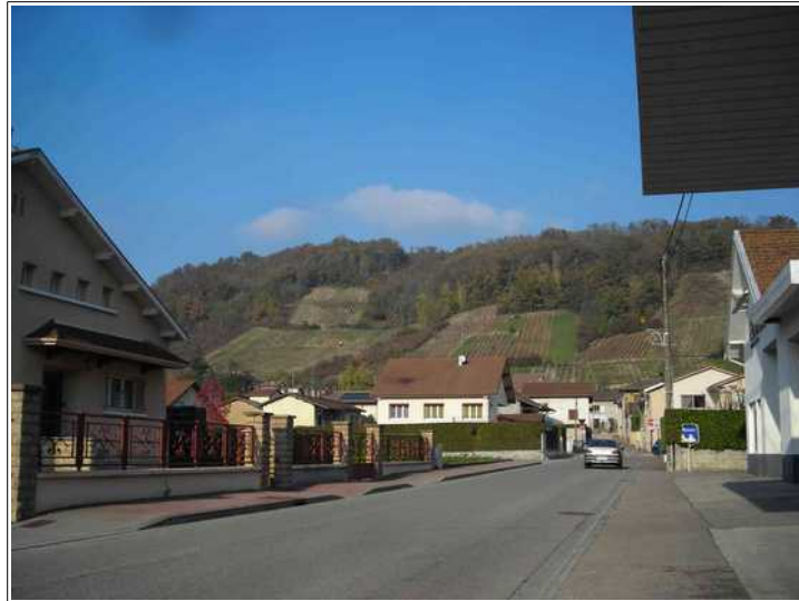
Vue générale du versant dominant le bourg (vignoble), les ruissellements atteignent le centre-ville en se propageant par les voiries (ici la rue de la BASCULE). Des inondations plus ou moins conséquentes en résultent.
