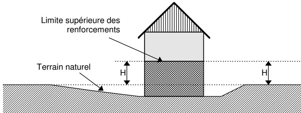
En cas de terrassements en déblais, la hauteur doit être mesurée par rapport au terrain naturel initial.
