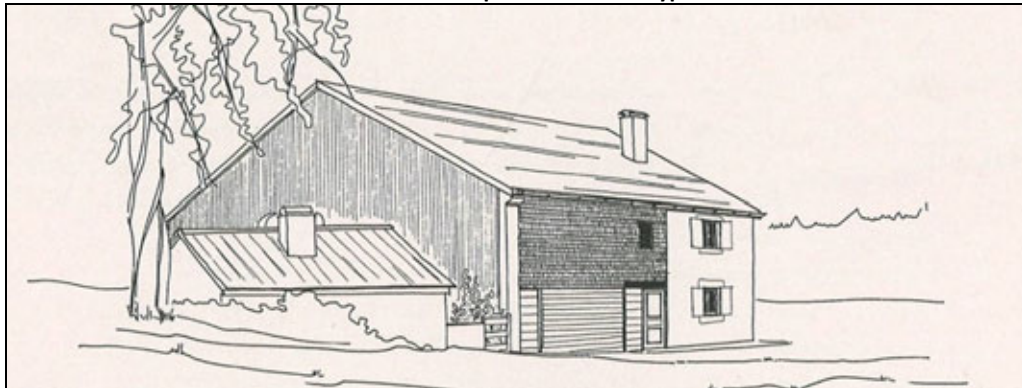
Galerie fermée par un matériau type bois
