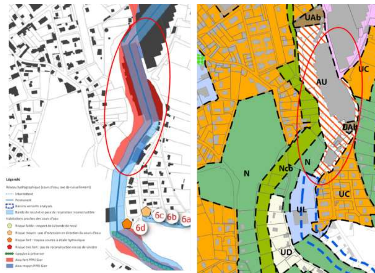
Figure 31 – Identification de la zone AU au niveau du Couzon où l'axe de ruissellement n'est pas repris sur le zonage (Source : Rapport R.0170-02 du 08/12/2015 et zonage du PLU)
