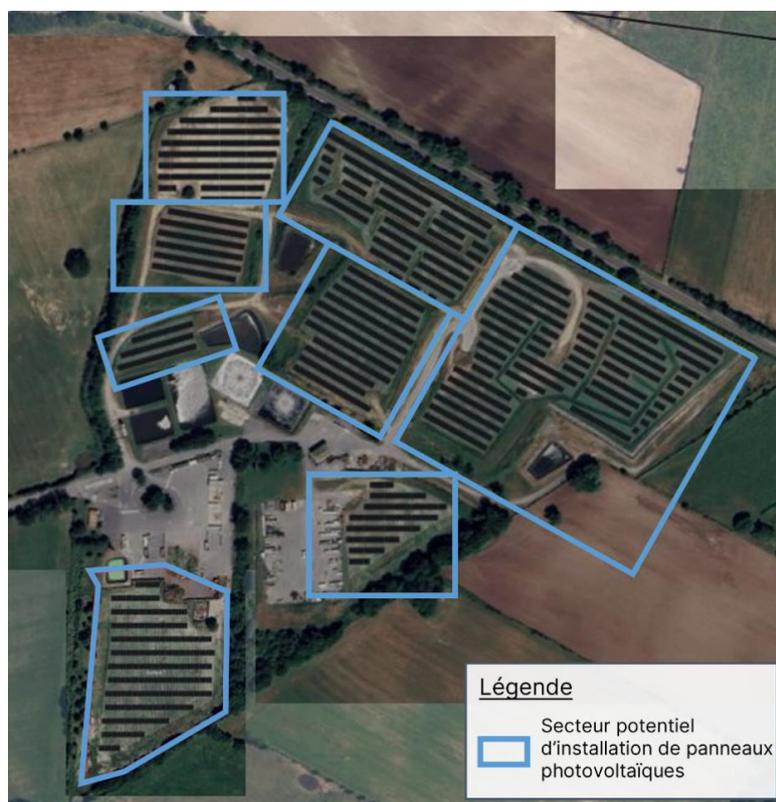
Figure 3 - Implantation envisagée des panneaux photovoltaïques
