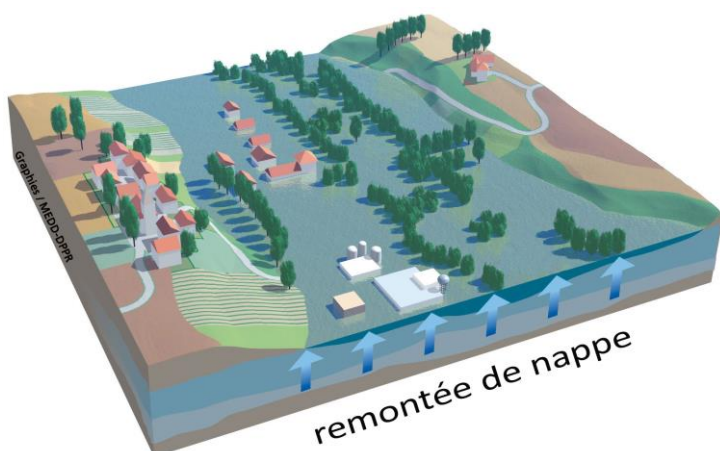
Inondations par remontée de nappes , source : BRGM
