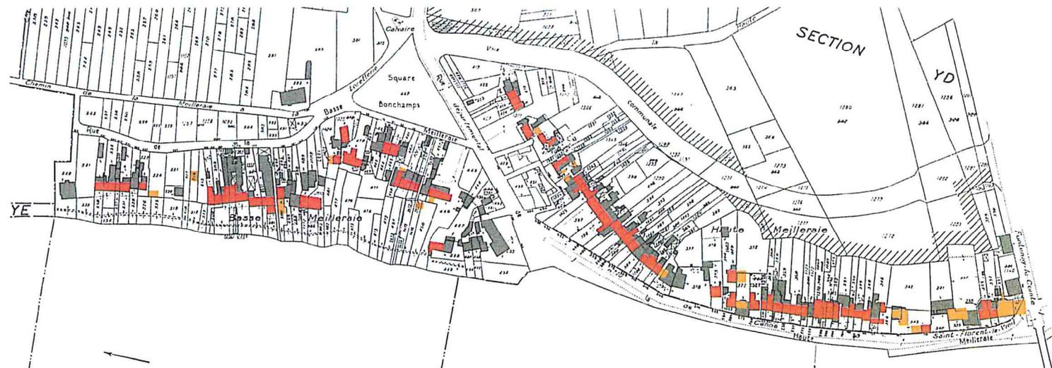
Cette image montre la superposition des implantations actuelles (traits noirs et surfaces grises) avec celles figurant sur le cadastre de 1813 (surfaces rouges et orangées). Les constructions en rouge sont celles qui existaient en 1813, et qui existent encore aujourd'hui. Celles en orangé existaient en 1813, et ont disparu. Celles en gris ont été implantées après 1813.
