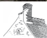
Cheminée en briques dont la souche est encadrée au nu extérieur du pignon : solution fréquente dans le Loiret.
