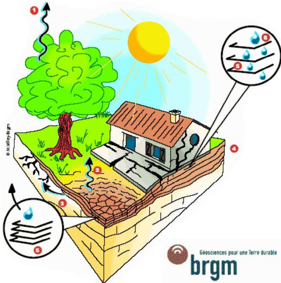
**Nature du phénomène** : un matériau argileux voit sa consistance se modifier en fonction de sa teneur en eau : dur et cassant lorsqu'il est desséché, il devient plastique et malléable à partir d'un certain niveau d'humidité. De plus, les modifications de consistance s'accompagnent de variations de volume, dont l'amplitude peut être parfois spectaculaire.
