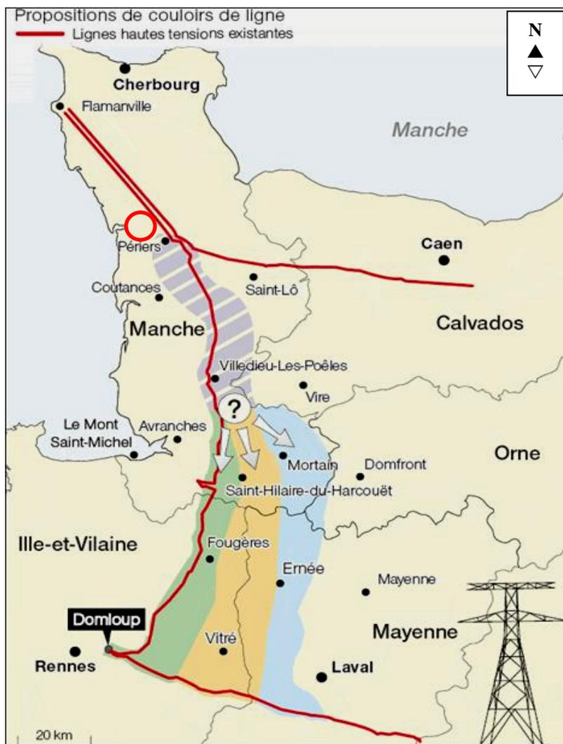
FIG 9 –Proposition de couloir de lignes Très Hautes Tensions (projet EPR à Flammanville)
