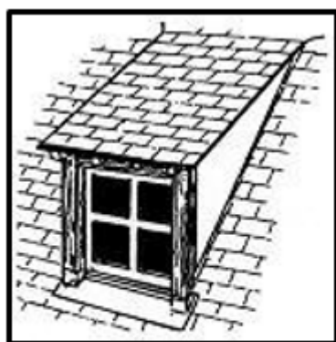
Lucarne rampante, dites en chien couché
