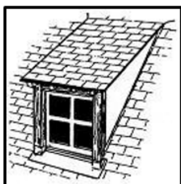
Lucarne rampante, dites en chien couché
