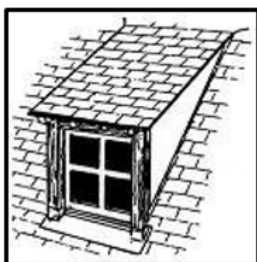
Lucarne rampante, dites en chien couché
