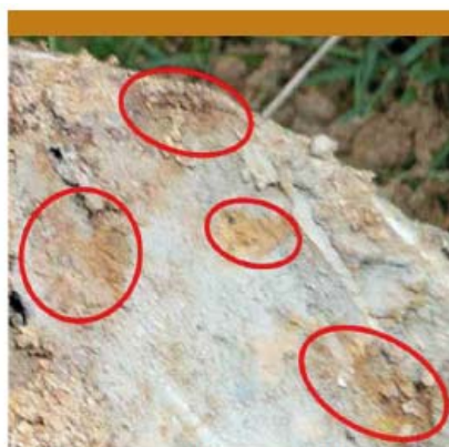
Traits rédoxiques (tâches rouille entourées en rouge) et traits réductiques (matrice bleu claire)
