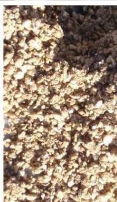
5. Examen du sol sur l'ensemble de la carotte prélevée : couleur, texture, structure. à droite, test de plasticité : pouvant former un boudin refermable en un cercle, le substrat présente 20 à 30% d'argile
