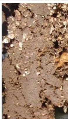
5. Examen du sol sur l'ensemble de la carotte prélevée : couleur, texture, structure. à droite, test de plasticité : pouvant former un boudin refermable en un cercle, le substrat présente 20 à 30% d'argile
