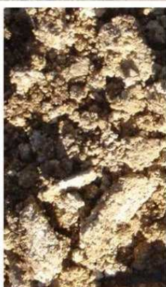
5. Examen du sol sur l'ensemble de la carotte prélevée : couleur, texture, structure. à droite, test de plasticité : pouvant former un boudin refermable en un cercle, le substrat présente 20 à 30% d'argile
