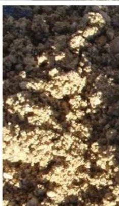
5. Examen du sol sur l'ensemble de la carotte prélevée : couleur, texture, structure. à droite, test de plasticité : pouvant former un boudin refermable en un cercle, le substrat présente 20 à 30% d'argile
