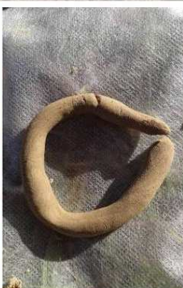
5. Examen du sol sur l'ensemble de la carotte prélevée : couleur, texture, structure. à droite, test de plasticité : pouvant former un boudin refermable en un cercle, le substrat présente 20 à 30% d'argile
