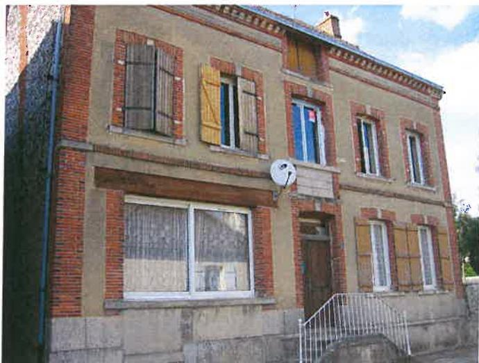
Les constructions anciennes présentent des caractéristiques architecturales propres à leur mode de construction. Ainsi, les chaînages d'angle et les encadrements d'ouvertures sont constitués de briques, parfois de bois pour les encadrements. La pierre n'est pratiquement pas utilisée pour ces éléments de structure. Par contre elle est souvent apparente lorsqu'elle constitue le matériau de gros œuvre des murs.
