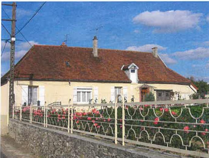
Les toitures les plus anciennes sont constituées de petites tuiles. L'ardoise, peu fréquente, est cependant présente sur quelques constructions.
