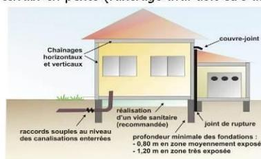
Prévoir des joints de rupture sur toute la hauteur entre les bâtiments accolés fondés différemment ou exerçant des charges variables
