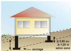
Assurer l'homogénéité d'ancrage des fondations sur terrain en pente (l'ancrage aval doit être au moins aussi important que l'ancrage amont)
