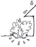
Le processus de réten-tion-infiltration se caractérise par la création dans le sol d'un espace de rétention perméable à l'eau pluviale, tel qu'un jardin de pluie, une noue, etc. Cet aménagement permet à l'eau d'être retenue partiellement et ponctuellement avant son infiltration dans le sol puis dans la nappe phréatique.
