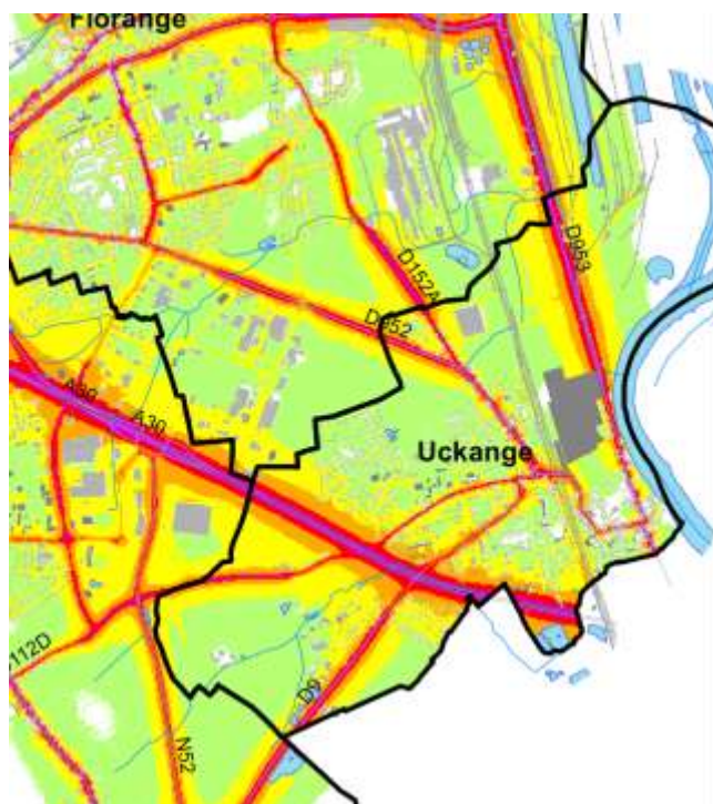
Niveaux de bruit induit par les infrastructures routières de nuit
