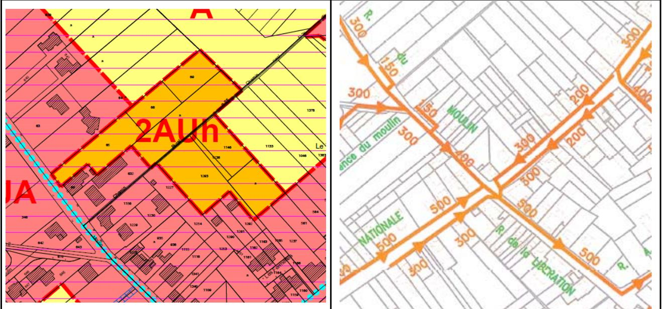
Le site est très bien desservi par le réseau d'assainissement collectif de la commune. Il est bordé par une conduite de 400 et une conduite de 300. La connexion au réseau d'assainissement est donc aisée. Les travaux seront toutefois à programmer.
