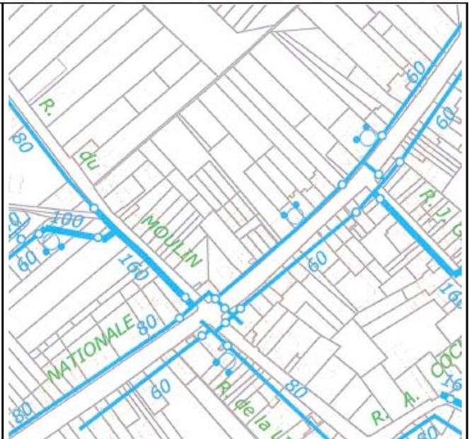
Le site est très bien desservi par le réseau d'eau potable. Il est bordé par des conduites de 160 mm sur sa limite sud et par une conduite de 60 mm sur sa limite est. La connexion au réseau d'eau potable est donc aisée. Les travaux seront toutefois à programmer.
