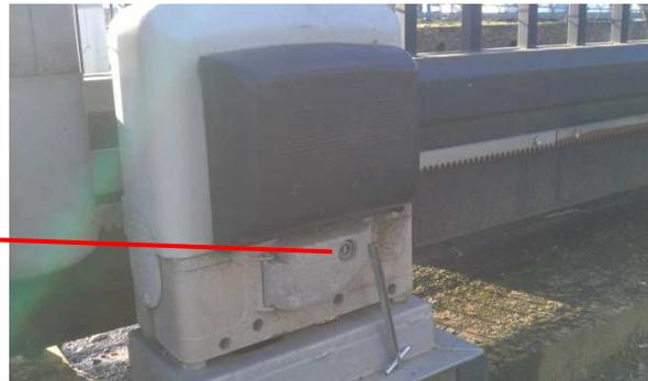
La polycoise permet d'ouvrir un coffret afin de déverrouiller la position électrique et donc procéder à l'ouverture manuelle d'un portail à commande électrique
