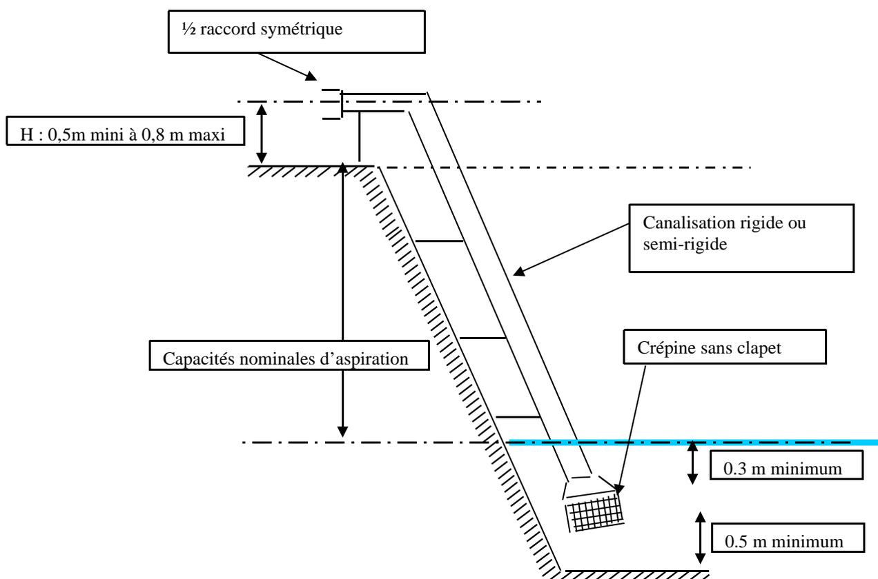
Dans le cas où plusieurs dispositifs similaires doivent être installés sur la même ressource, ils doivent être distants de 4 m au moins l'un de l'autre.
