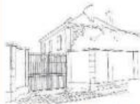
Portail en ferronnerie de même hauteur que le mur d'encadrement enduit
