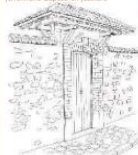
Portail entre jambages et linteau cintré en brique, surmonté d'un auvent charpenté à quatre pans recouvert de tuile, caractéristique d'une époque et d'un style de vilas
