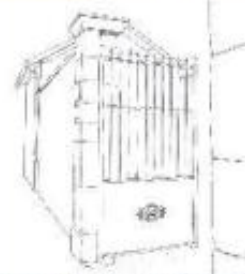
Mur et pignon maçonnés avec portail en ferronnerie disposé en feuillure
