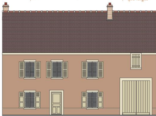
Une surépaisseur d'enduit, non moulurée, parachève simplement les encadrements des portes et fenêtres
