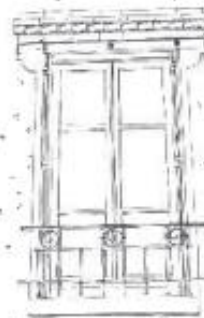
Fenêtre à persiennes métalliques dans un mur en moellon. Le linteau métallique est support de briques décoratives. L'encadrement de la baie est en enduit lissé
