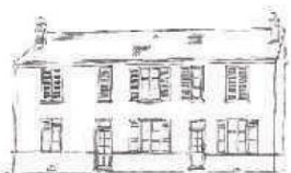
Les ouvertures des maisons rurales sont ordonnancées horizontalement et verticalement
