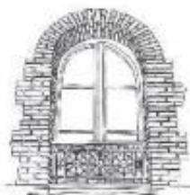
Ouverture avec encadrement en brique, linteau cintré, appui de fenêtre en pierre et garde-corps en ferronnerie
