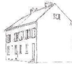
Faitages, égouts de toiture et linteaux alignés sur deux maisons mitoyennes. L'ouverture dans le pignon n'est pas dans l'axe du faitage
