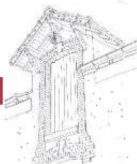
Lucarne à engranger engagée dans le toit, pour accès à l'étage dit "à encadrement"
