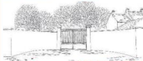
Portail en ferronnerie encadré par des piles en pierre, en retrait dans les murs de moellon enduit, en deux-tiers
