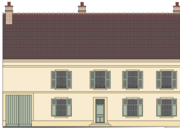
Faitages, égouts de toiture et linteaux alignés sur deux maisons mitoyennes. L'ouverture dans le pignon n'est pas dans l'axe du faitage
