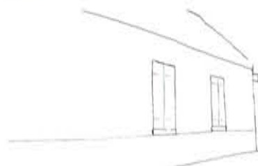
Les ouvertures sont inscrites aléatoirement dans la façade mais les linteaux sont alignés
