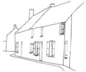
Les ouvertures sont inscrites aléatoirement dans la façade mais les linteaux sont alignés
