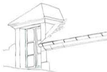
Lucarne engagée dans la toiture composée d'une structure bois, et d'une toiture à trois pans
