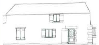
Les ouvertures sont inscrites aléatoirement dans la façade mais les linteaux sont alignés
