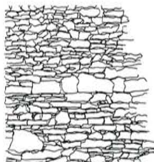
Mur rural de pierre sèche, monté sans mortier avec un appareillage restant apparent
