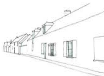
Les ouvertures sont inscrites aléatoirement dans la façade mais les linteaux sont alignés
