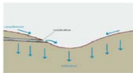
Schéma d'une noue de d'infiltration (www.crit.archi.fr)
