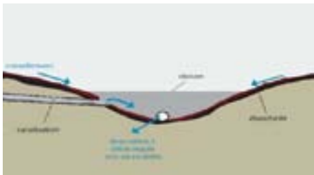
Schéma d'une noue de rétention (www.crit.archi.fr)
