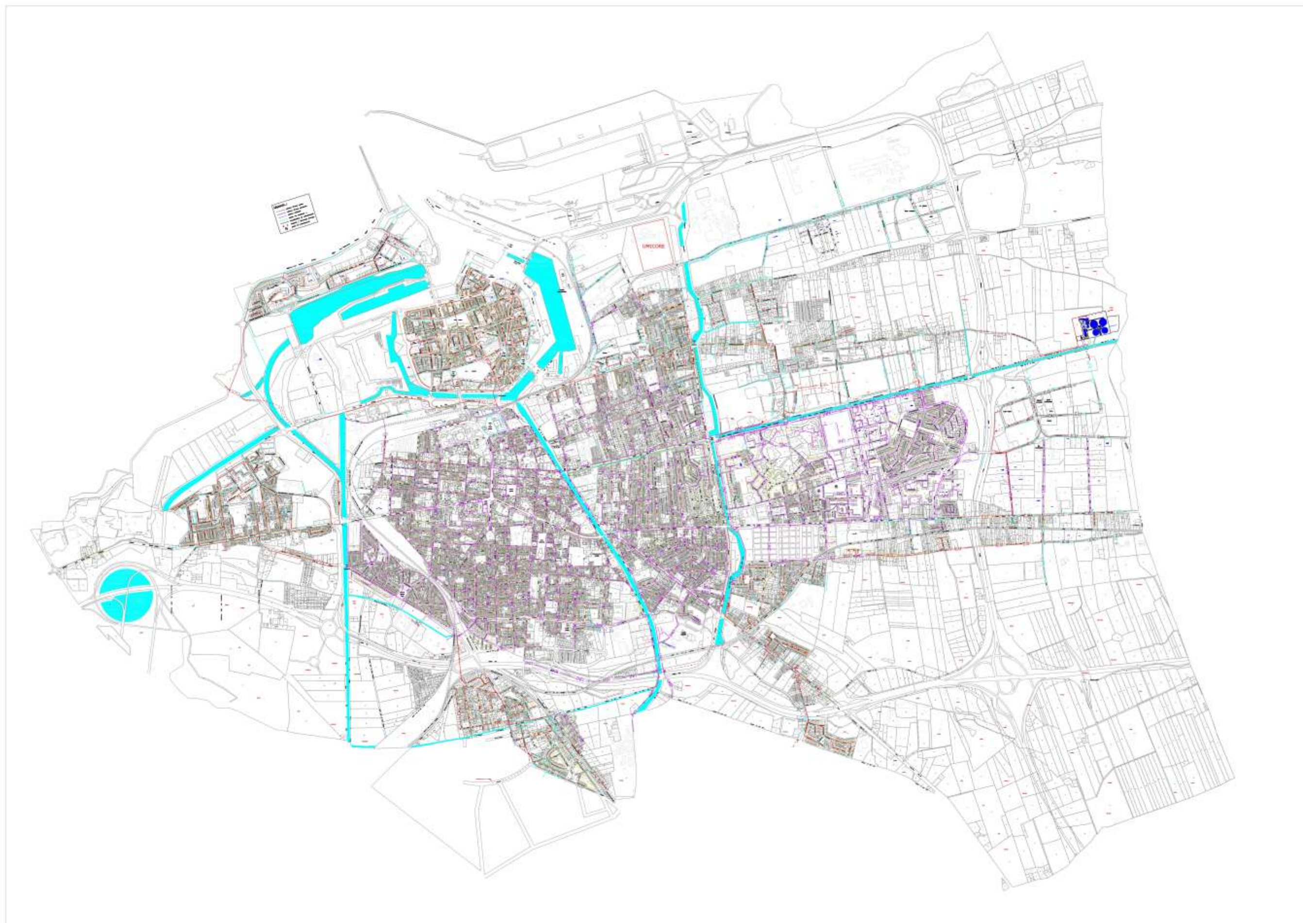
Plan des réseaux d'assainissement eaux usées
