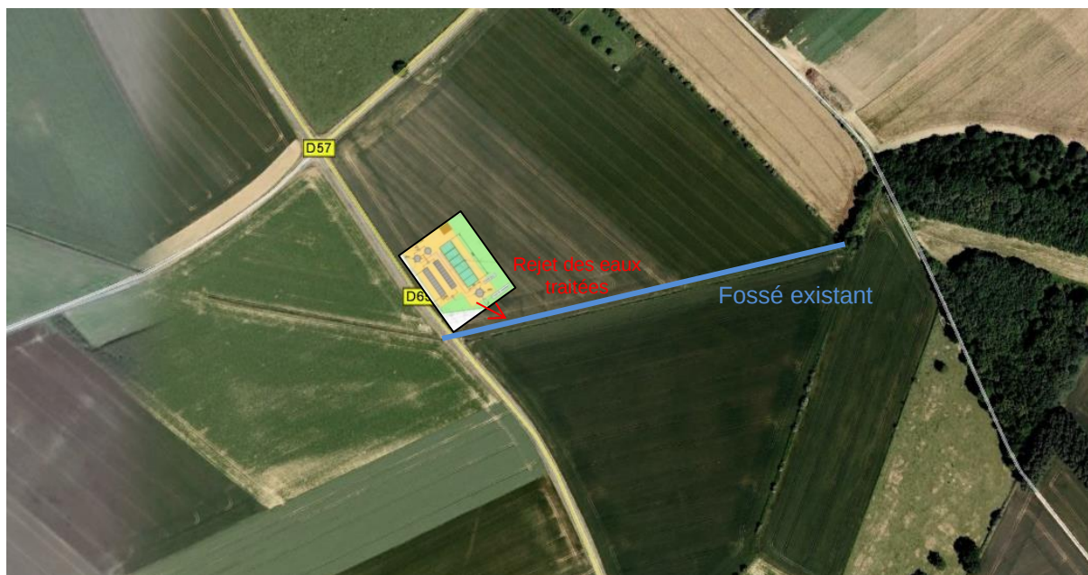
Fig. 6. Rejet de la station d'épuration
