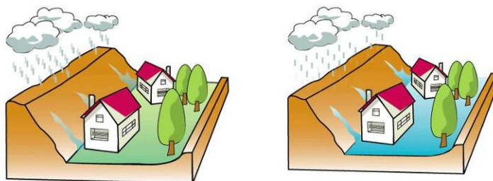
Schéma explication de l'inondation par ruissellements
