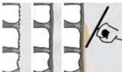
L'enduit chaux en 3 passes, gobettis, corps d'enduit et finition talochée.
