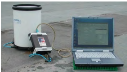
Figure 5 - Pluviographe numérique et son enregistreur lors d'une relève
