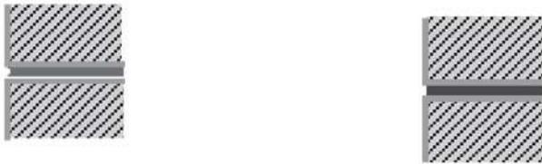
les joints peuvent être refoulés au montage voici deux exemples de ce type : joint en demi jonc et joint en creux.
