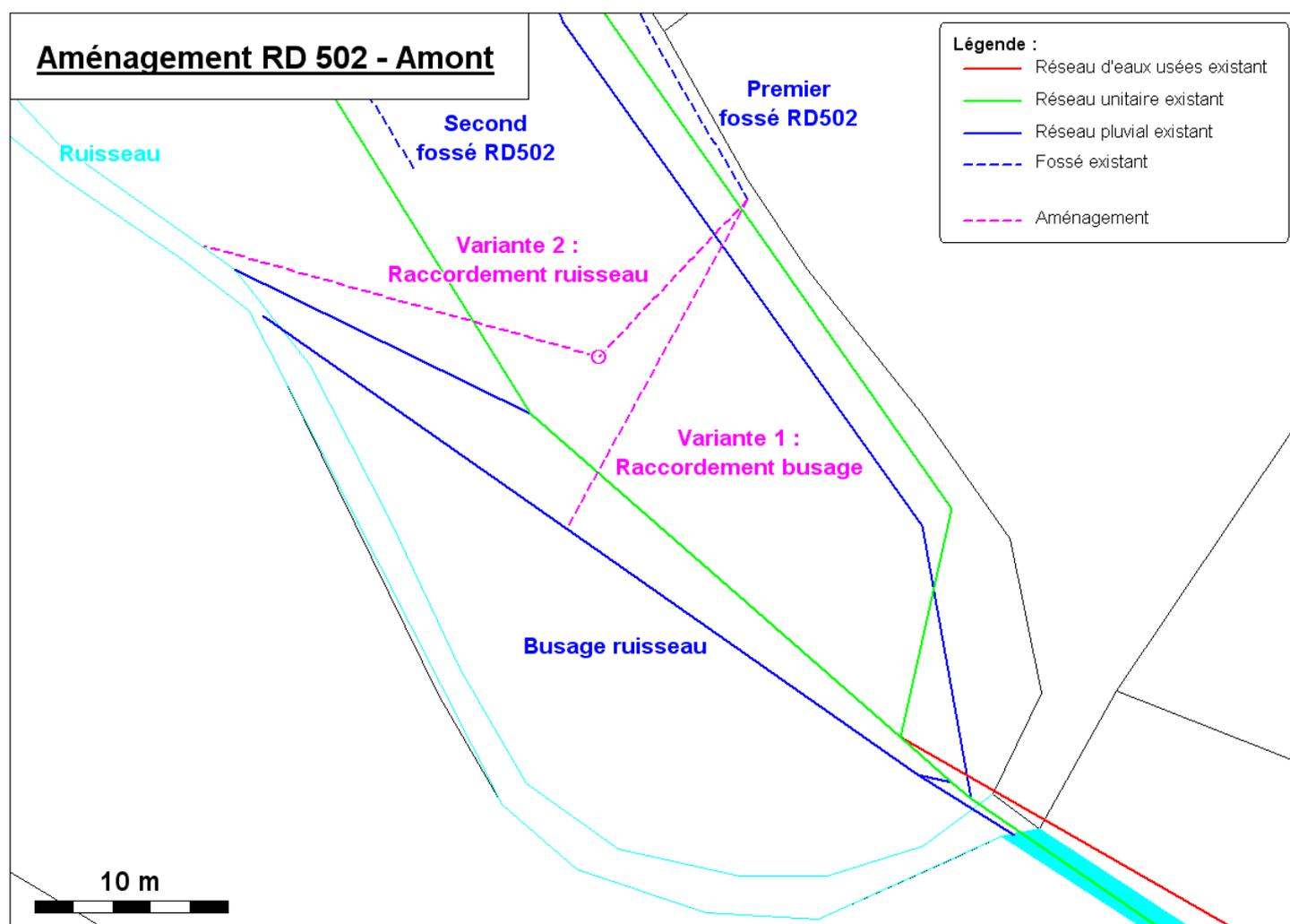
En amont du croisement du chemin des Pères, il est proposé de mettre en œuvre un ouvrage d'entonnement à l'extrémité du fossé, suivi d'une buse de franchissement de diamètre 400 mm sur un linéaire de 10 ml afin de traverser la chaussée. Il conviendrait d'enrocher la zone de réception des eaux collectées par le busage.
