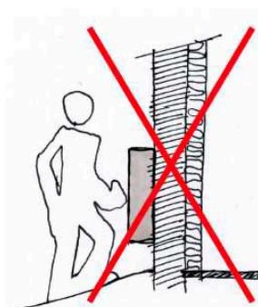
Élément non intégré à la façade
