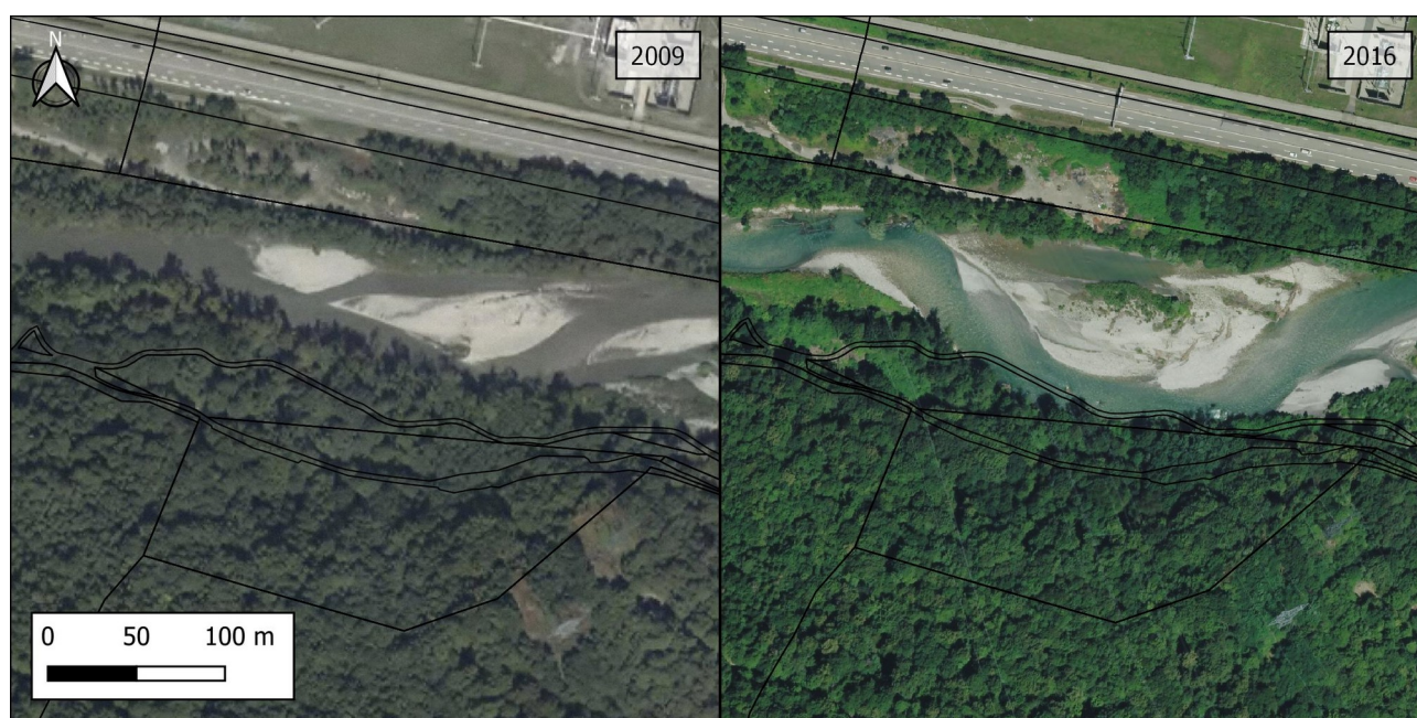
Figure V.8: évolution de l'érosion de berge entre 2009 et 2016.
