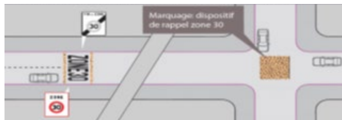
Marquage d'entrée et de rappel d'identification en zone 30
