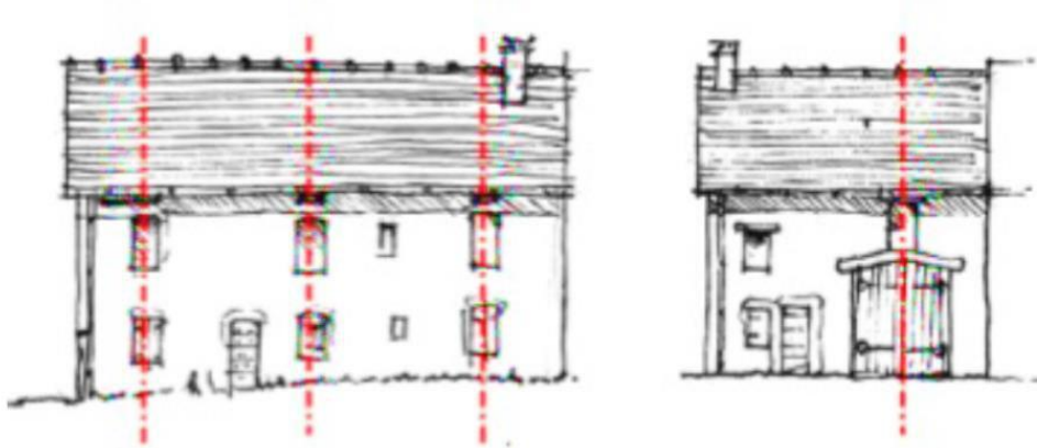
Schéma n°10 : Principe du respect des ouvertures dans le cadre de projets de réhabilitation
