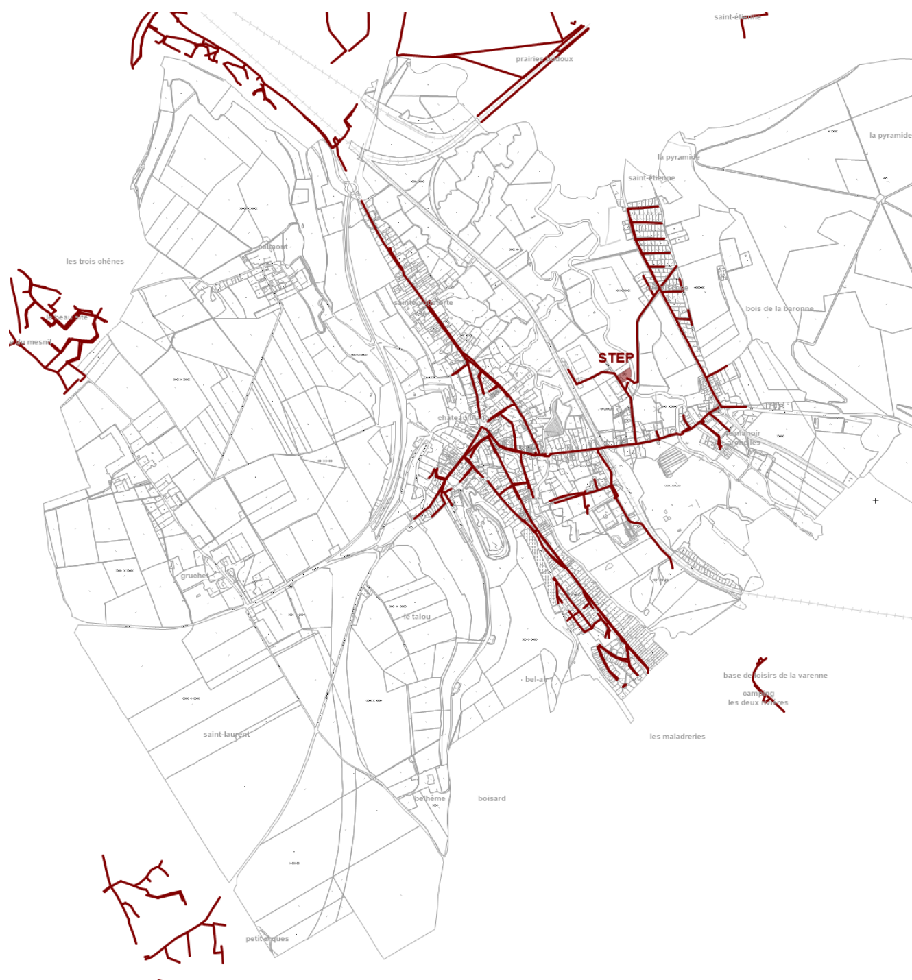
Figure 130 : Réseau d'assainissement (source : Dieppe Maritime)
