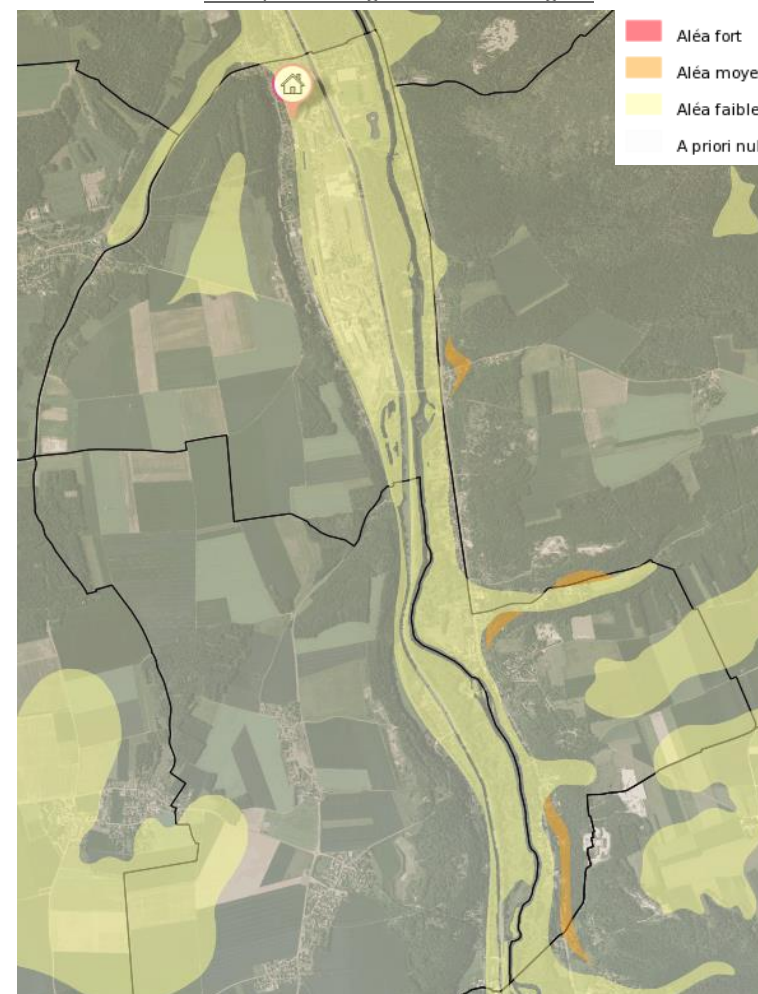
Le risque retrait-gonflement des argiles
