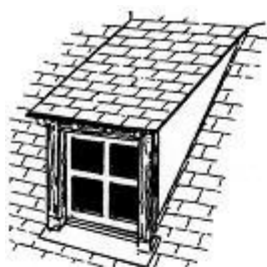
lucarne rampante ou en chien couché
