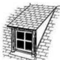
lucarne rampante ou en chien couché
