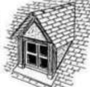
lucarne à deux pans dite jacobine, en bâtière ou à cheval
