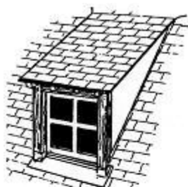
lucarne rampante ou en chien couché
